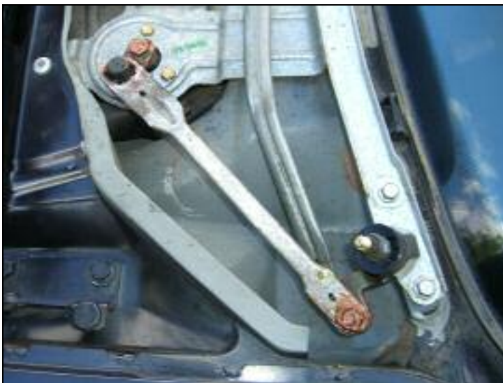
Abb. 16 Nahaufnahme der geschmierten Gelenke Wischergestänge, linke Seite
